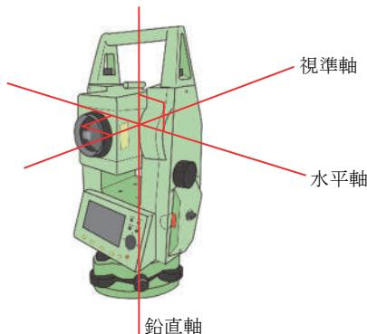
鉛直軸はトータルステーションを水平方向に回転させるための軸、水平軸はトータルステーションを鉛直方向に回転させるための軸、視準軸は視準する望遠鏡の中心の軸となる。
