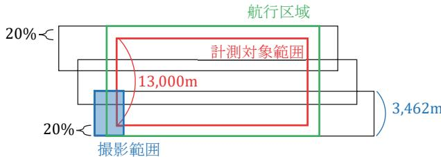
計測対象範囲の短辺（南北）は  $13,000\text{m}$  であるが、航行区域には、計測対象範囲の短辺の両端に撮影区域外を画面の大きさ（空中写真の撮影範囲の大きさの長辺）の  $20\%$ 以上含む必要があるため、航行区域の短辺は、 $13,000 + 3,462 \times 0.2 \times 2 = 14,384.8\text{m}$  となる。
