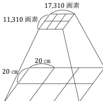
撮影基準面における空中写真の撮影範囲の大きさは、デジタル航空カメラの画面の大きさ（画素数）×撮影基準面における地上画素寸法となる。よって、長辺が  $17,310 \times 20\text{cm} = 3,462\text{m}$  で、短辺が  $11,310 \times 20\text{cm} = 2,262\text{m}$  の範囲が、1枚の空中写真で撮影できる範囲の大きさとなる。
