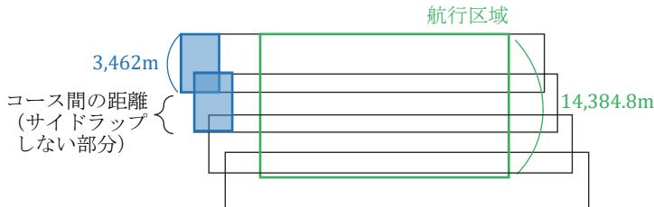
航行区域の短辺（南北）が 14,384.8m であり、撮影範囲の長辺（南北）が 3,462m である。N コースあたりの撮影範囲は、サイドラップの重複度を 30% とするため、 $3,462 + (N-1) \times \text{コース間の距離} (3,462 \times 0.7)$  m となる。
