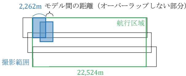
航行区域の長辺（東西）が22,524mであり、撮影範囲の短辺（東西）が2,262mである。N枚あたりの撮影範囲は、オーバーラップの重複度を60%とするため、 $2,262 + (N-1) \times \text{モデル間の距離} (2,262 \times 0.4) \text{ m}$ となる。
