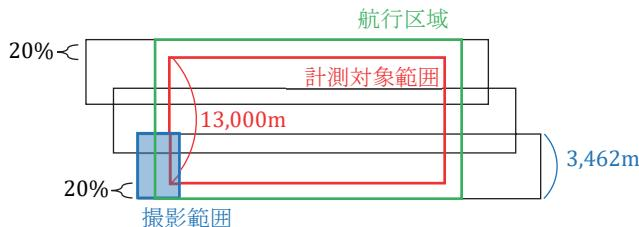
計測対象範囲の短辺(南北)は  $13,000\text{m}$  であるが, 航行区域には, 計測対象範囲の短辺の両端に撮影区域外を画面の大きさ(空中写真的撮影範囲の大きさの長辺)の  $20\%$ 以上含む必要があるため, 航行区域の短辺は,  $13,000 + 3,462 \times 0.2 \times 2 = 14,384.8\text{m}$  となる。
